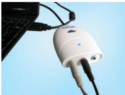
EC31U 采用弧线半圆型设计，尾部是一根与 PC 机连接的 USB 线缆；前端是三个音频信号的输出输入插座，其中：
